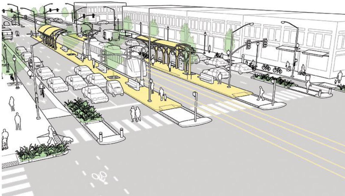
Illustratsioon: Näide eraldatud ühissõidukirajast ja peatusest tänava keskel (Urban Street Design Guide, NACTO)
