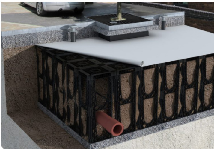
Skeem 2. Vaade pinnasemahutile, kus on integreeritud nii õhutus- kui kastmissüsteem, juuresuunaja, juurekaitserest koos tüvekaitsega (võimalik edasimüüja/toode The Green Blue Urban Arborsystem v Milford Tree Root system Root cells, fotol toode Arborsystem).
